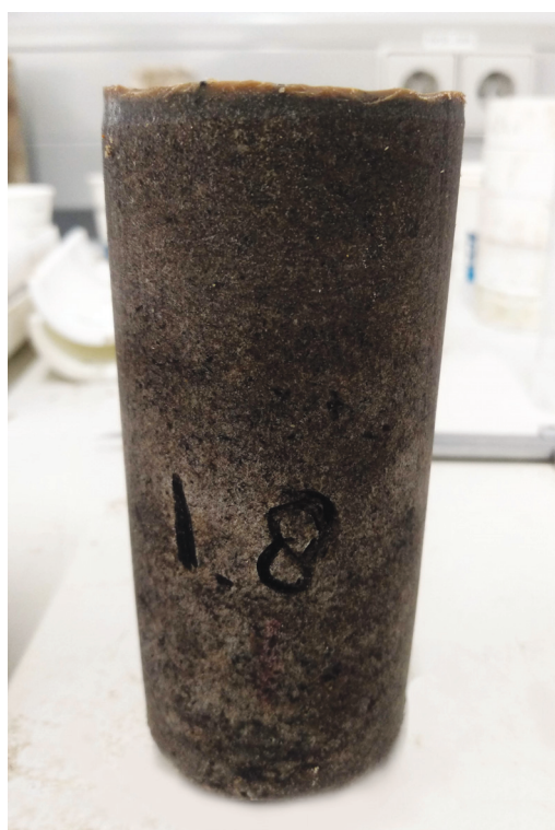
Figuur 1 – Kernen van zand, organische stof en hard gel zoals geprepareerd voor druksterkte beproeving in het laboratorium. Links is een kern met 2% organisch stofgehalte en rechts een kern met 8% organisch stofgehalte.
